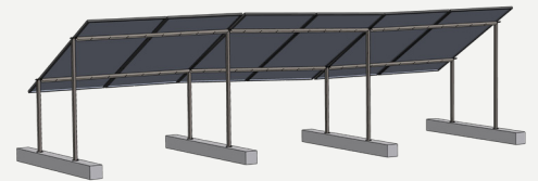
Solpanelstativ med betongfundament som följer mark
